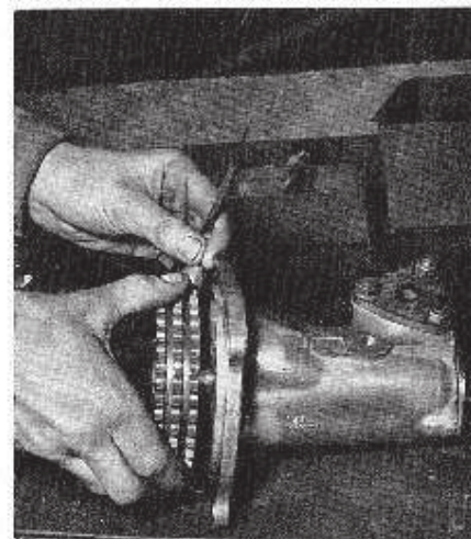
Fig. 16 — Vérification de jeu longitudinal de l'entraînement auxiliaire.
