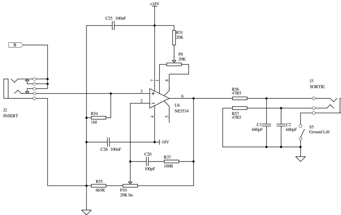
Le gain de l'étage est ajustable de 1 a 25db par P10.
