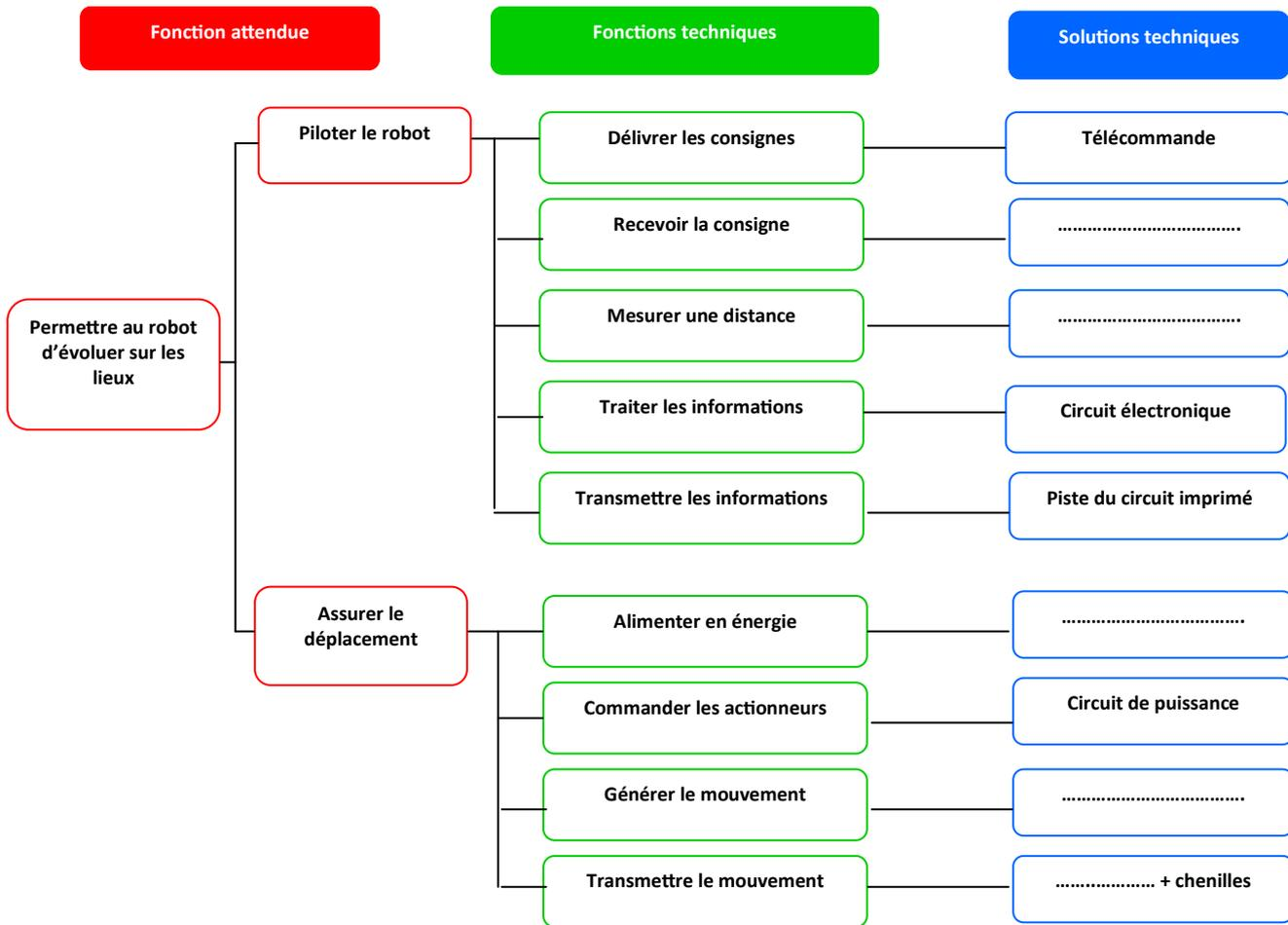
2. Compléter la chaîne de l'énergie et la chaîne d'information du robot avec le nom des éléments présents sur le dessin du robot.
