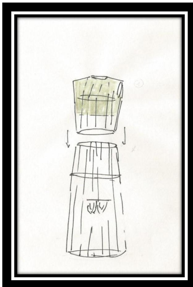
2. Attacher la tête au buste. Les vis de la tête passent à travers une plaque de bois qui se trouve dans le buste en aluminium.
