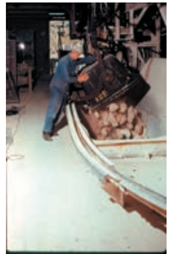
Transporteur aérien : déchargement des bennes à Dombasle : le déchargement a toujours été manuel
