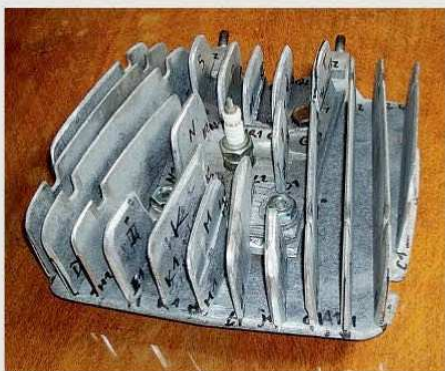
▲ Réorientation des ailettes de la culasse.
