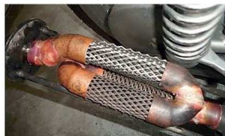
▼ L'intérieur du nouveau pot d'échappement.
