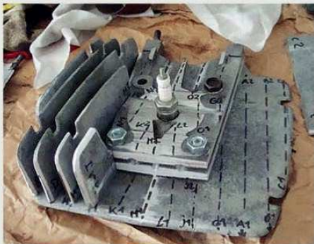
▲ Préparation des ailettes pour la transformation de la culasse de la 250 ETZ.
