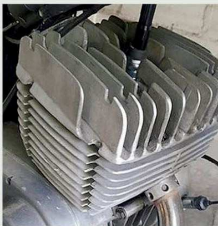
▲ Résultat final des ailettes soudées au moteur.
