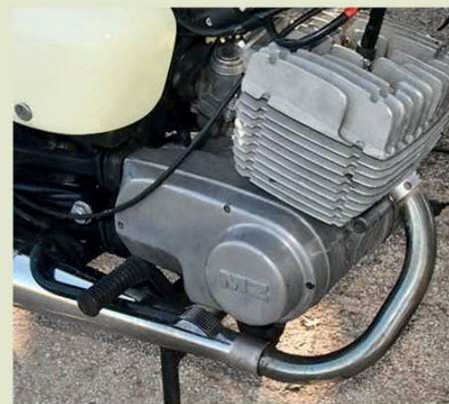
▲ Augmentation de cylindrée pour le moteur qui monte à 291 cm 3 .
