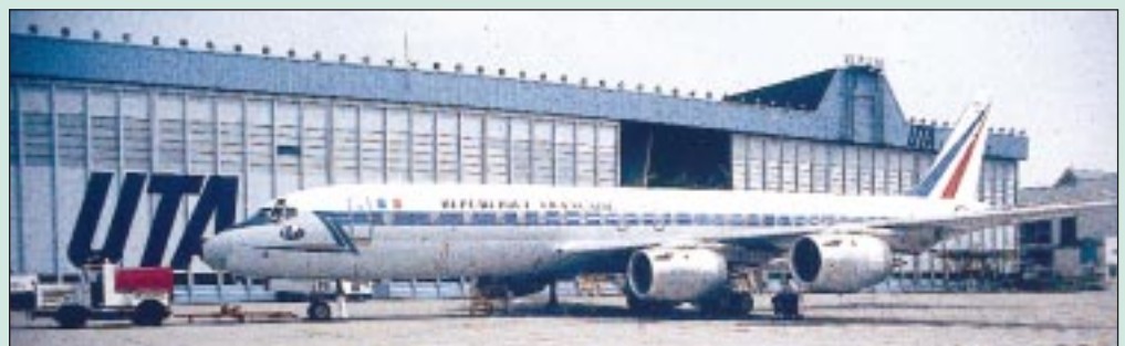
Sortie du premier DC8-72 remotorisé CFMSE.
