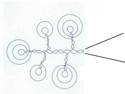
Laissez un peu « d'amorce » au fil de cuivre pour le fixer dans les trous du tamis en le tournant sur lui-même pour l'attacher. Couper la partie superflue.
