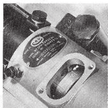
Fig. J8. Le jeu du rotor de la pompe d'injection
