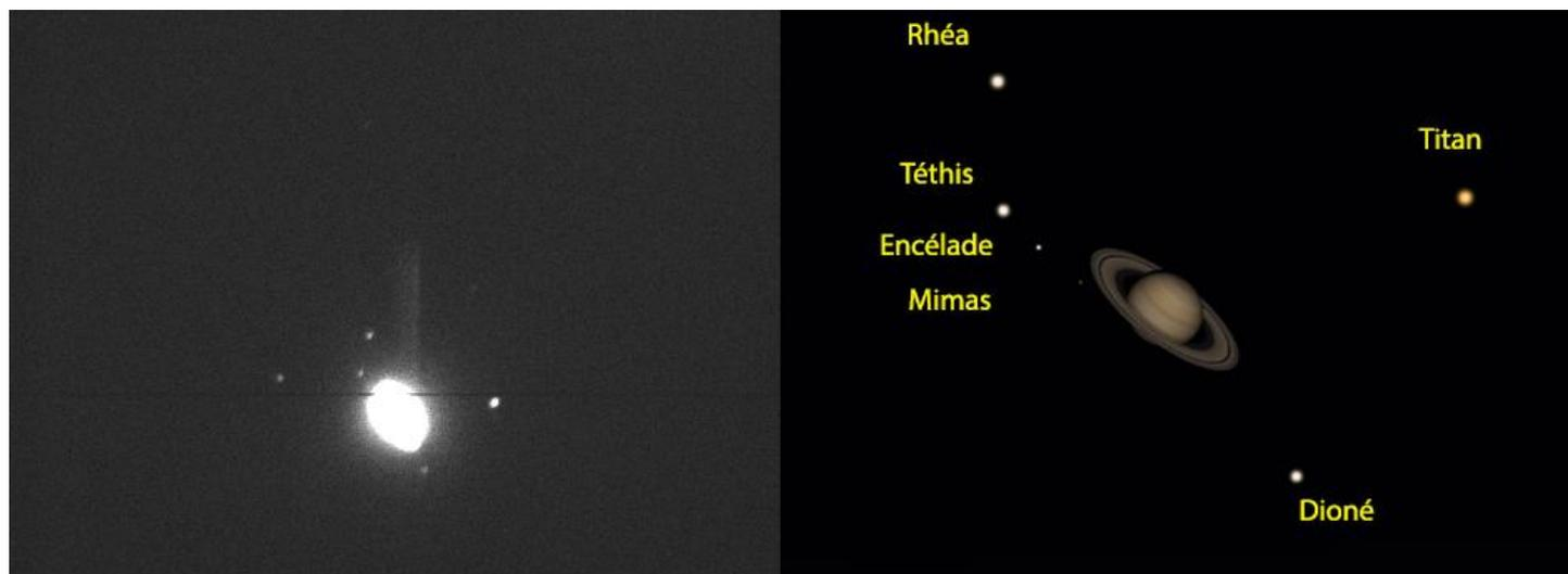
On va placer la fente du spectrographe sur les côtés les plus externes des anneaux, on fera la mesure d'un côté puis de l'autre. On va faire 3 poses de 120 secondes par côté, pour avoir un bon signal sur bruit.
