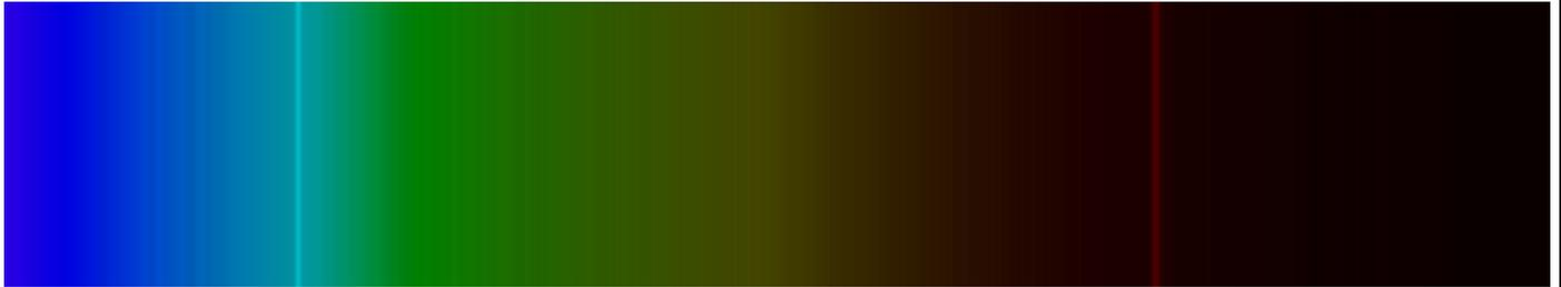
Spectre Navi (bleu) avec le logiciel Visualspec; les raies d'émission et absorption de l'élément Hydrogène (en Vert)  $H\alpha=6563\text{\AA}$ ,  $H\beta=4861\text{\AA}$ ,  $H\gamma=4340\text{\AA}$
