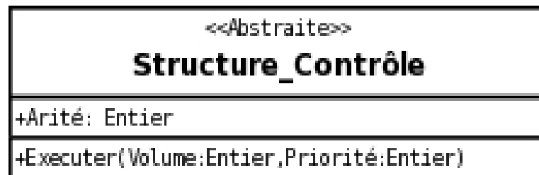
Figure IV.6 Diagramme de la classe abstraite des structures de contrôle.
