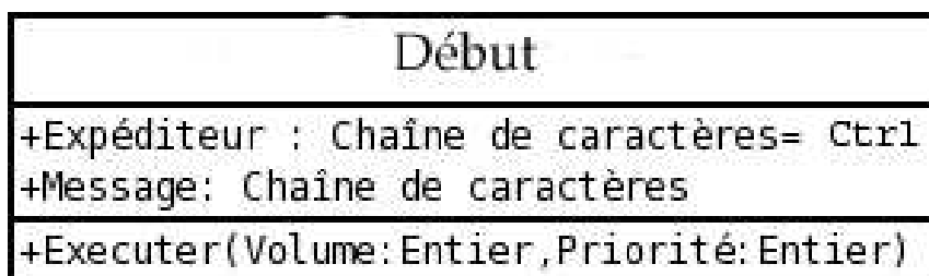
Figure IV.11 Diagramme de classe de la primitive de début.
