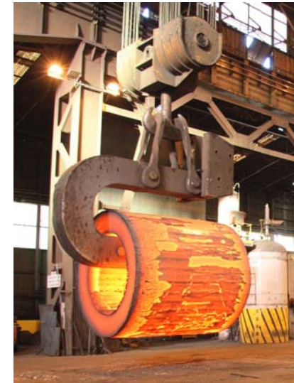
Manipulation d'une virole en cours de forgeage (document Areva Creusot Forge)
