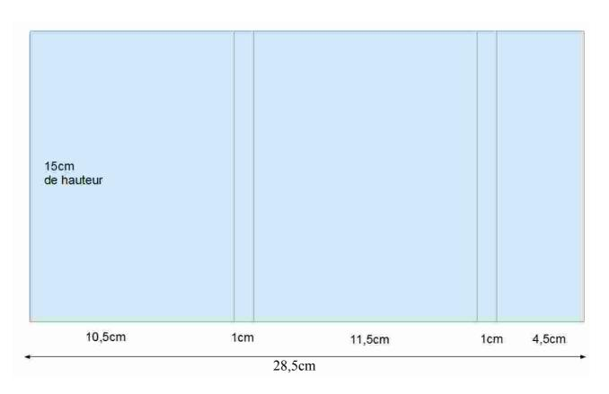
Découper la cartonnette au niveau des contours extérieurs Avec une règle plate, marquer les plis intérieurs
