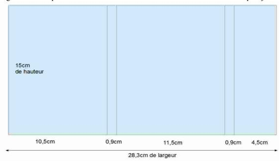
Découper la cartonnette au niveau des contours extérieurs Avec une règle plate, marquer les plis intérieurs.
