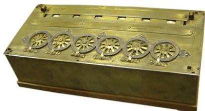
**1642** : Pascal réalise une première machine mécanique permettant d'additionner ou de soustraire deux nombres
