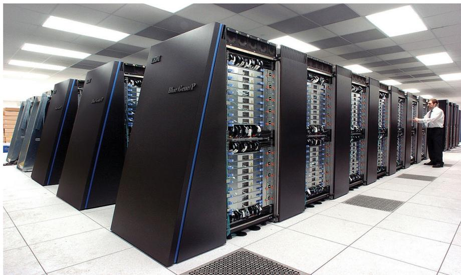
**2004** : Supercalculateur IBM Blue fonctionne avec 250 000 processeurs utilisant un système de refroidissement standard par air
