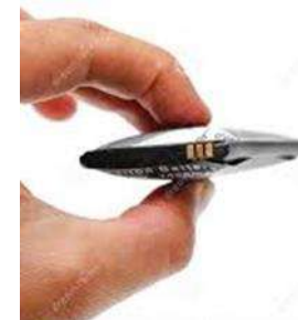
Batterie de téléphone gonflée
