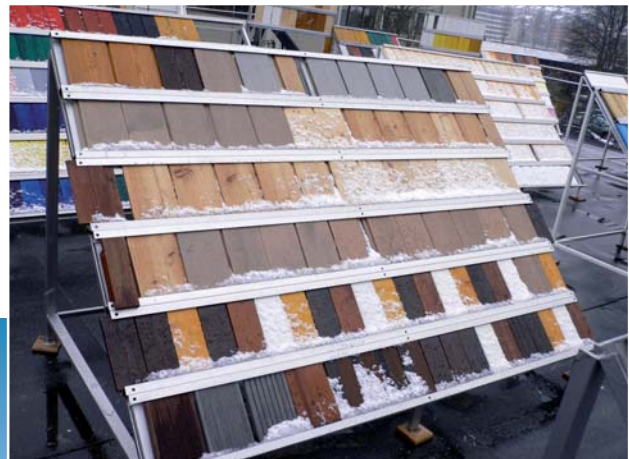
Le toit de l'un des bâtiments est mis à profit pour les tests des différentes formules en cours de développement.
