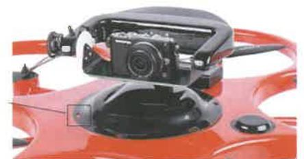
Figure 2bis. Vue avec la nacelle supérieure surtout utile pour les inspections
