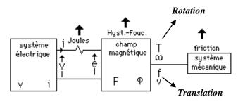
Production d'énergie mécanique : Moteur
