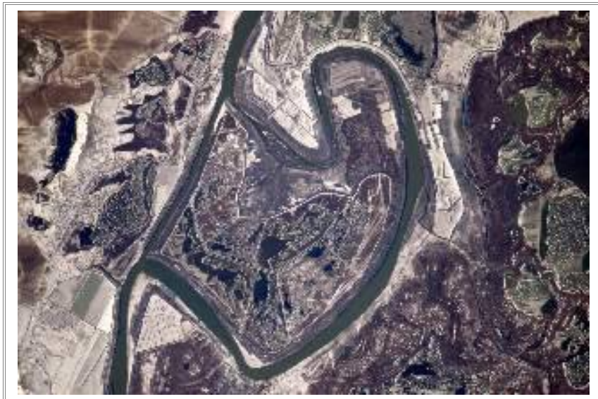
Méandre dans le delta du Danube. Il a été coupé par un canal artificiel pour faciliter la navigation
