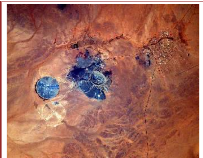
Mine d'Akjoujt (Fort-Repoux, Mauritanie). On y extrait du cuivre et de l'or, au prix d'une pollution visible. Notez les deux cercles de près de 1,2 km de diamètre qui servent de bassin de rinçage du minerai.
