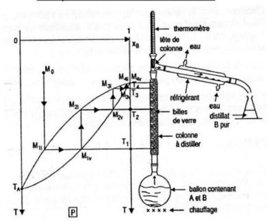
En s'aidant du schéma ci-contre, décrire ce qui se passe (entre autres dans la colonne à distiller) lors de la distillation fractionnée du mélange de A et B, lorsque l'on part des conditions représentées par le point
