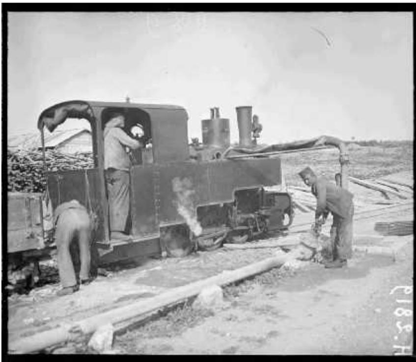
**Réf. SPA 70 H 2819** – *Le remplissage des caisses à eau d'une locomotive Decauville 030T, à Vasiluk (Macédoine)*
