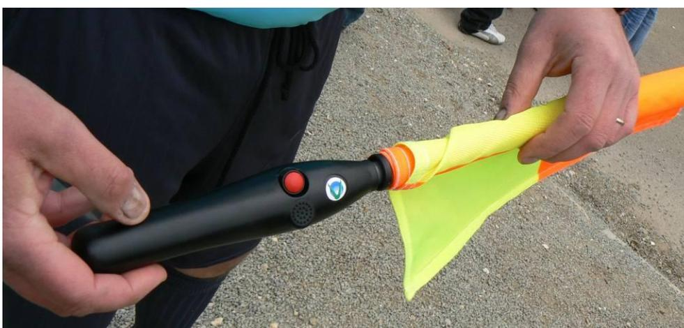
Nouveauté technique pour nos arbitres, des drapeaux qui permettent de donner un signal vibrant à l'arbitre central par appui sur le bouton rouge - Au top !
