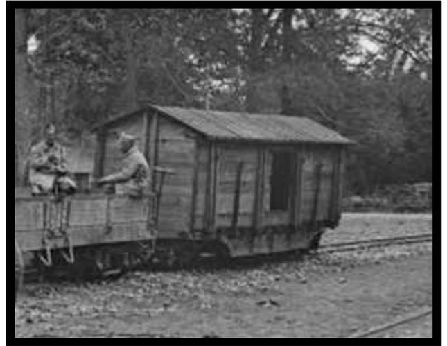
**Réf. SPA 41 BO 1935** – Marcaulieu (Meuse). Decauville de ravitaillement (vue partielle). Un wagon couvert sur plate-forme Péchot.
