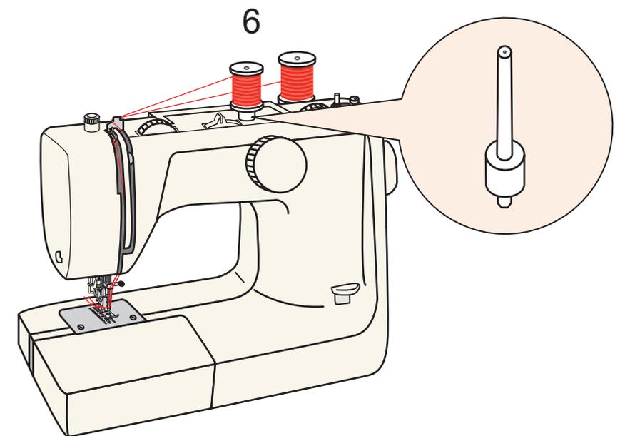
Mettre en place la tige porte bobine optionnelle et la garnir d'une bobine.
