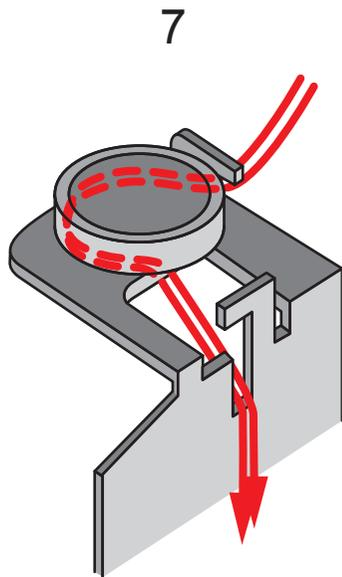
Tirer les fils des deux bobines et les faire passer par les guides fil et la poulie de pré tension.
