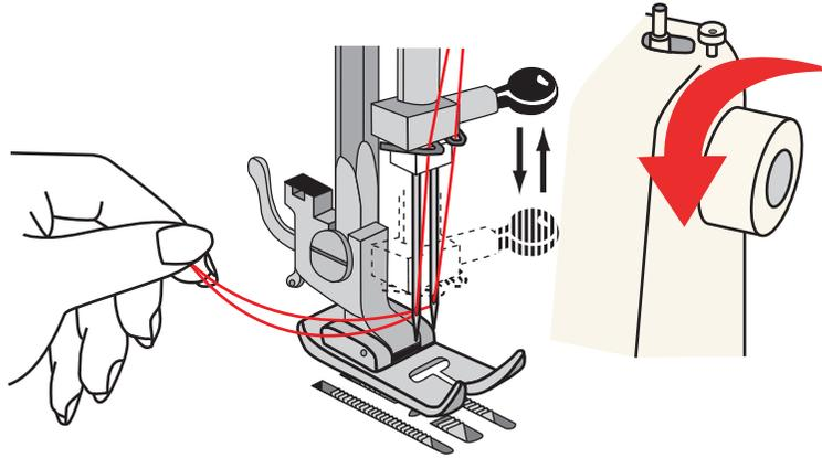
Tenir les fils de la main gauche, tourner le volant vers soi de la main droite, pour que l'aiguille effectue un aller retour...
