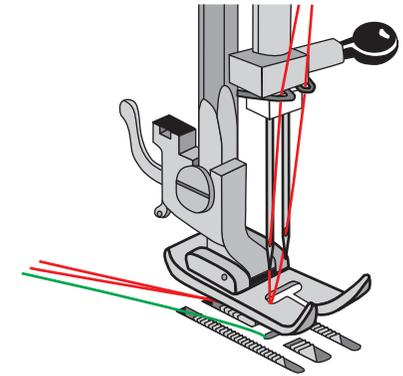
Puis tirer les 3 fils vers l'arrière en passant ceux de l'aiguille dans la fente du pied de biche.
