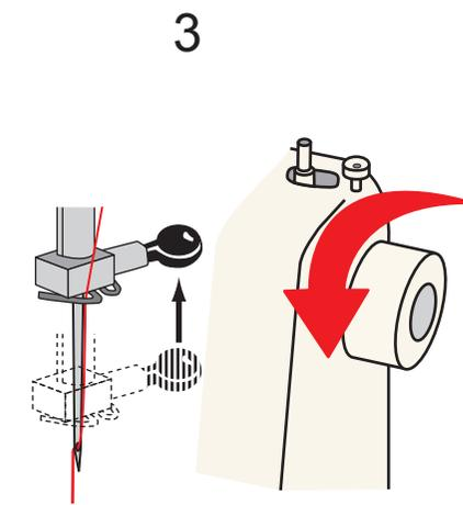
Tourner le volant vers soi pour remonter l'aiguille en position haute.
