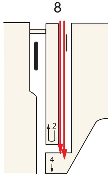
Descendre les fils en les glissant à gauche du disque de tension.
