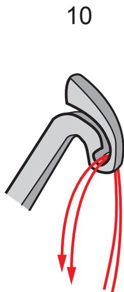
Passer les fils dans le bras releveur que l'on fait remonter en tournant le volant manuel vers soi.
