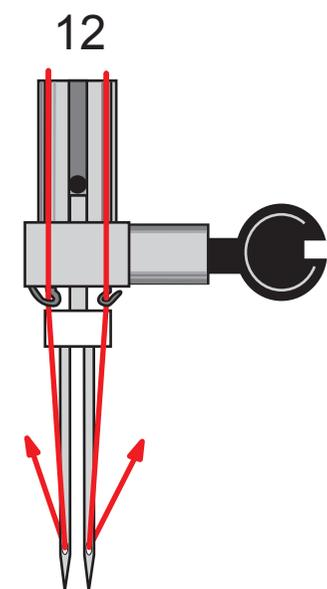
Séparer les fils en les faisant passer par les guides de droite et de gauche, puis enfiler les aiguilles vers l'arrière.
