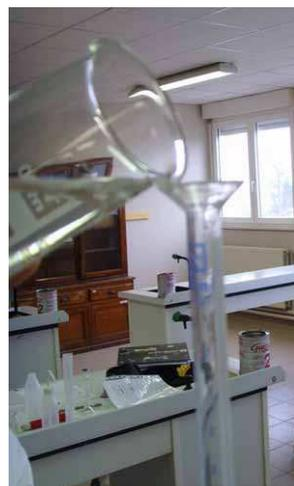
Rincer la burette graduée avec la solution qui va être utilisée (soude ici) en laissant s'écouler la solution sur les parois...
