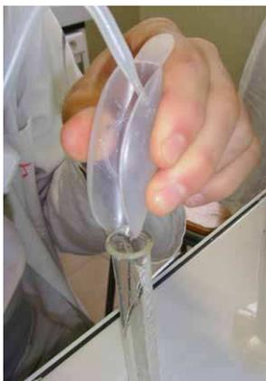
Transvaser le détartrant dans la fiole jaugée en utilisant la capsule de pesée et une spatule.
