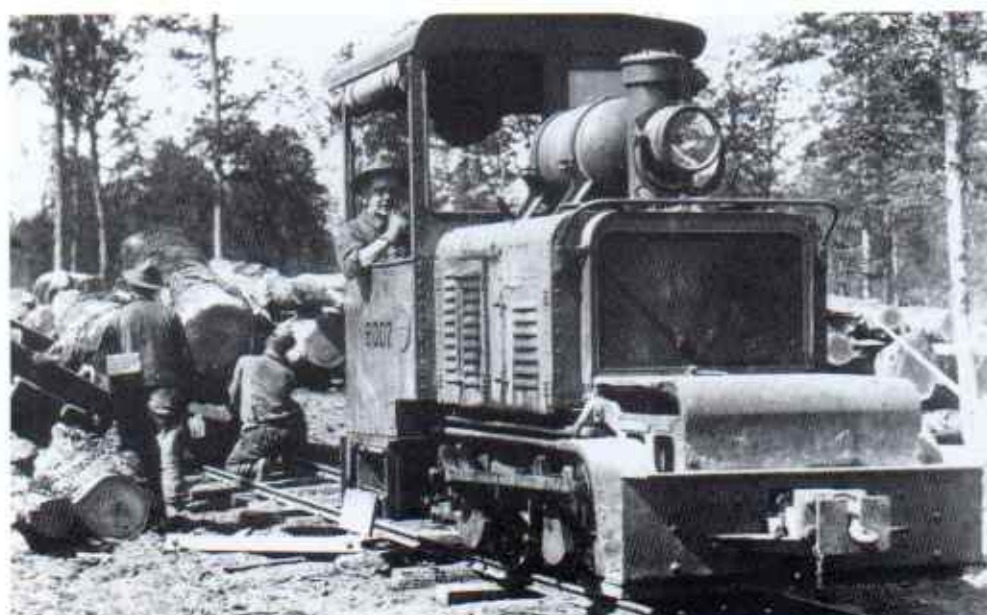
Juillet 1918 près d'Éclaron (Haute- Marne) : locotracteur Baldwin s'appêtant à manœuvrer des wagons de grumes présentement dérailés (coll. L. Chanuc).
