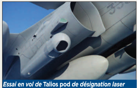
Essai en vol de Talios pod de désignation laser
