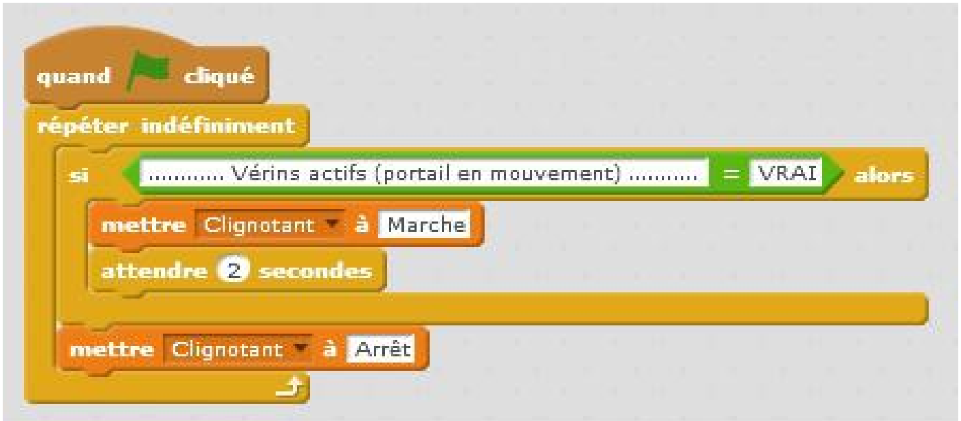
Doc.6 : Sous-programme « Sécurité » écrit en SRCATCH et géant le feu clignotant orange
