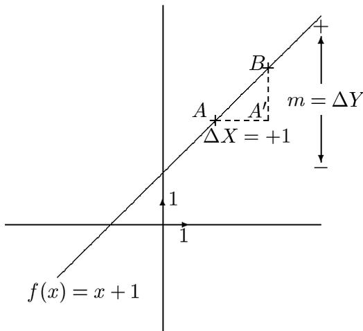
A partir d'un point  $A(x_A; y_A)$  connu sur la droite  $D$  et en s'imposant un déplacement  $\Delta X = +1$ , on remarque que la lecture directe de la mesure  $m$  qui sépare le point de coordonnées  $A'(x_A + 1; y_A)$  et la droite  $D$  donne le coefficient directeur au signe près :
