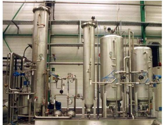
Fig. 3 – Installation de traitement d'une eau minérale Carbo-gazeuse. Le dégazeur sous vide est la première colonne à gauche (© Christ AG)
