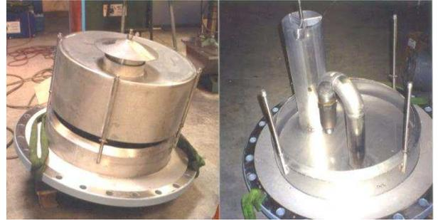
Fig.6 – Module d'atomisation 30 T/h
