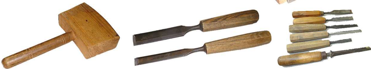
Ciseaux à bois (lames en acier chromé "Peugeot") à manipuler sous l'action percutante du maillet.
