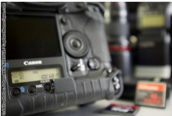
Une grande ouverture (f/2.8) provoque une faible profondeur de champ
