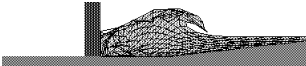
Fig. 11 - Influence de la profondeur pour un piston se déplaçant à 1 m/s, au même instant, t=0,58 s. Le sommet de la vague se déplace à peu près à la même vitesse (double de celle du piston) dans les trois cas. La base de la vague se propage d'autant plus vite que la profondeur est grande.
