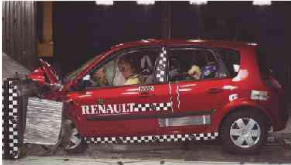
Pour être homologués, les véhicules subissent des crash-tests à 56km/h contre un mur (chocs frontaux)
