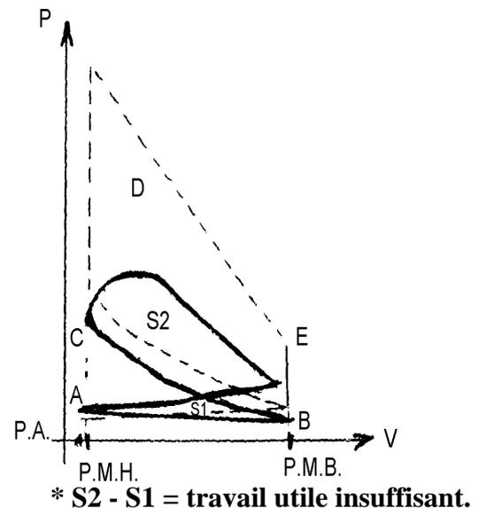
**3- DIAGRAMME REEL APRES REGLAGE :****- Avance à l'ouverture de l'admission (A.O.A) :**
