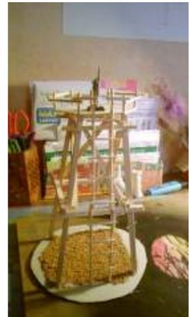
J'ai découpé 4 poutrelles de 100mm de long et 4mm d'épaisseur et 2 poutrelles de 110mm de long et 6mm d'épaisseur. Les 4 poutrelles sont venues renforcer la partie inférieure de la tour. Les deux poutrelles de 6mm ont été biseautées et placées sur chaque diagonale latérale. Ceci a permis de renforcer l'ensemble de la structure et donne un aspect plus solide à la tour.
