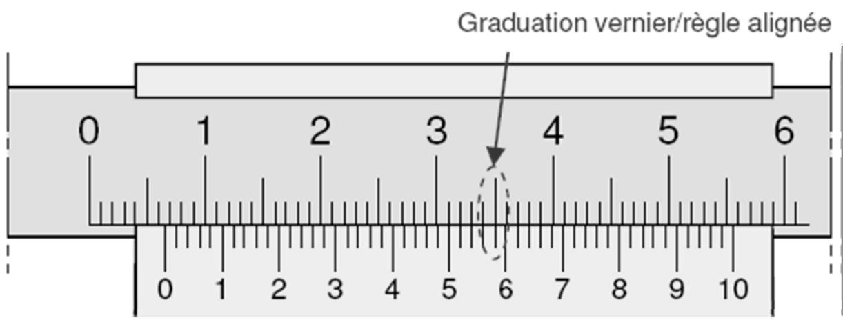
1- Nombre de millimètres avant le 0 du vernier = 6 mm.
