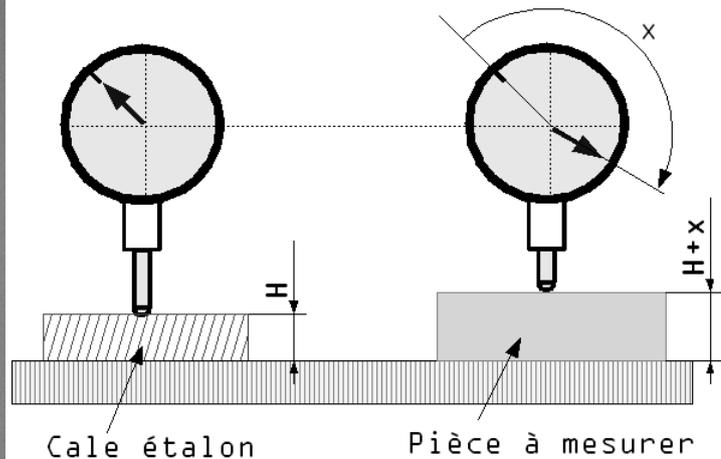
Le comparateur est constitué d'une tige mobile en translation. Le déplacement de cette dernière est transmis à un dispositif mécanique transformant la translation de la tige en rotation de l'aiguille. L'angle total de rotation est proportionnel au déplacement en translation de la tige.
