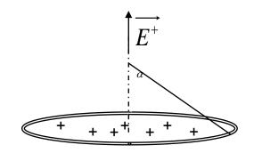
D'où le champ crée au point M par les deux disques chargés : (M à l'intérieur du cylindre)
