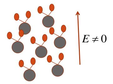
L'application d'un champ électrique Tend à orientés les dipôles suivant La direction de E et l'agitation thermique Tend à créer le désordre
