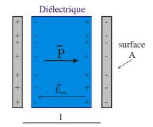
Si la polarisation est perpendiculaire à la normale de la surface du diélectrique :
